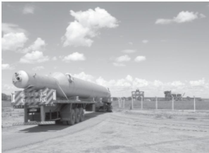
Colunas de inox fazem parte do destilador da usina Paranaíba
